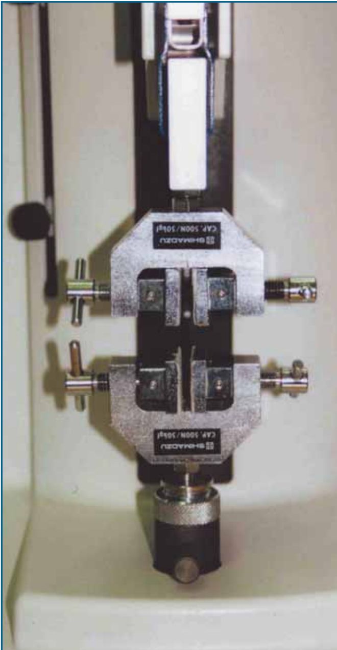
Abbildung 5: Zugprüfmaschine mit Klemmbacken zur Untersuchung freier Filme.
